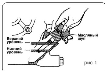
5. Выверните пробку маслозаливного отверстия в узле вибратора и проверьте уровень масла. При проверке убедитесь, что виброплита расположена строго горизонтально. Уровень масла должен быть до масляной пробки. Ежемесячно или через каждые 200 часов работы заменяйте масло (рис. 2.1 и рис. 2.2).
