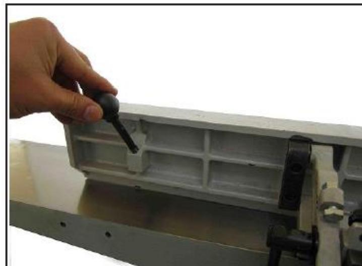
*Рис. 12. Установка рукояток наклона параллельного упора*
