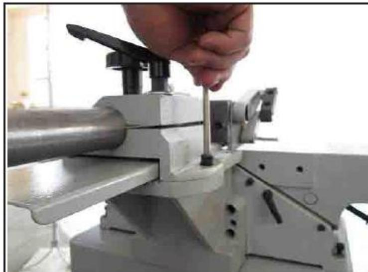
Рис. 10. Узел каретки параллельного упора
