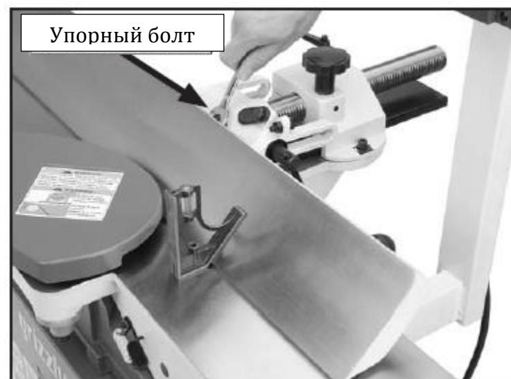
Рис. 29. Контргайка упора под угол 45° положения параллельного упора
