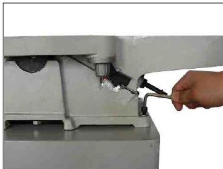
Рис. 4. Установка переднего крепёжного болта
