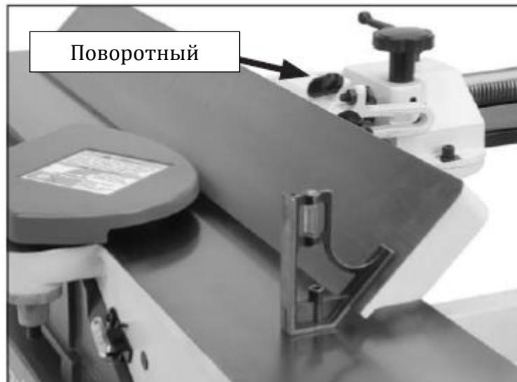
Рис. 28. Регулировка параллельного упора под углом 45° наружу
