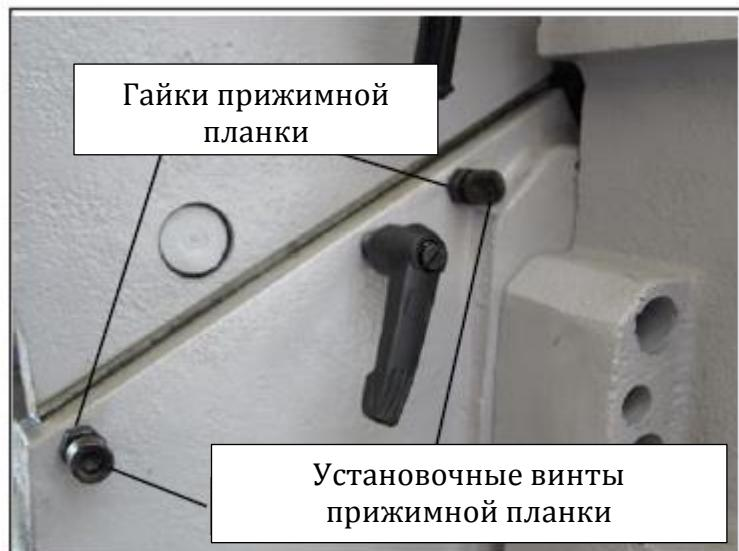
*Рис. 30. Органы регулировки прижимных планок выводного стола*
