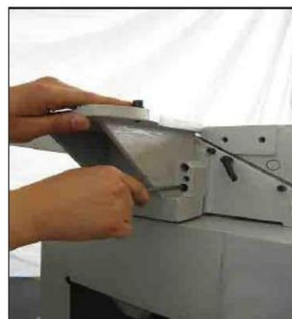
Рис. 9. Собранный кронштейн крепления каретки
