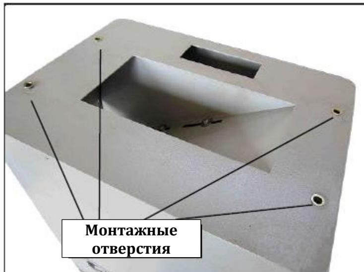
Рис. 3. Монтажные отверстия
