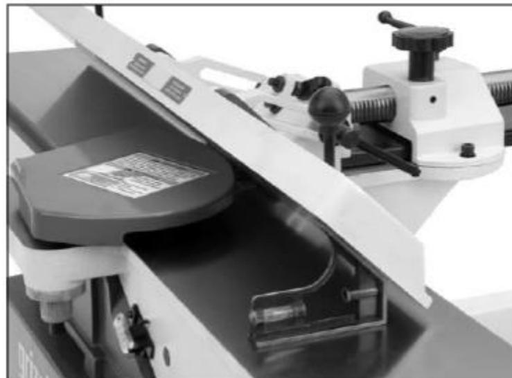
Рис. 24. Настройка под угол 45° внутрь
