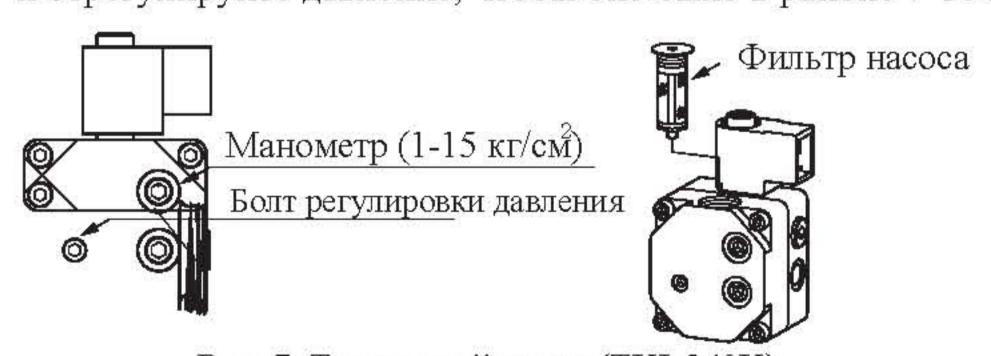
Рис. 7. Топливный насос (ТКІ-240K)
