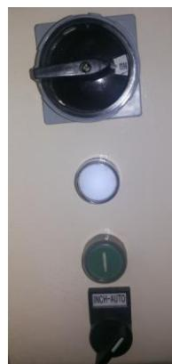
3) Эта машина работает в двух режимах: один - автоматический, а другой - пошаговый. В режиме автоматической работы, пожалуйста, установите переключатель на авто, затем нажмите на педаль, лезвие опустится. Если вы уберете ногу, то лезвие поднимется. Повторите это для следующей работы.
