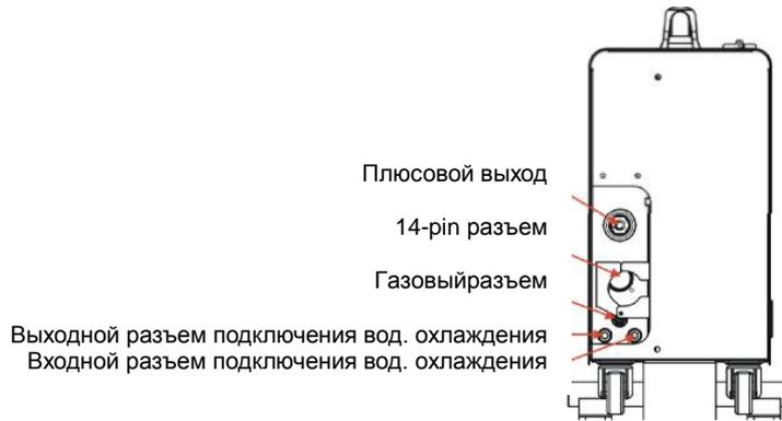
**Задняя панель сварочного источника:**
