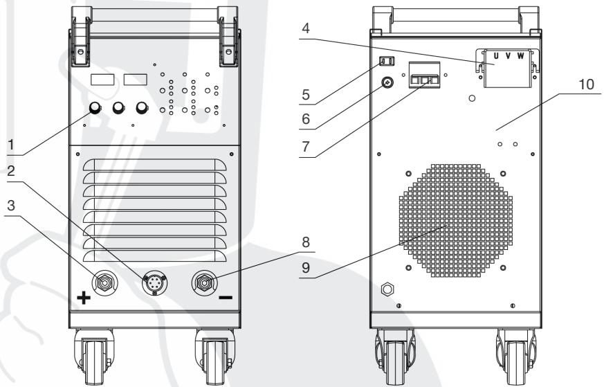
1. Панель управления инвертора: информационный дисплей, выбор функций и параметров сварки, фактический ток, напряжение, и т.д.
