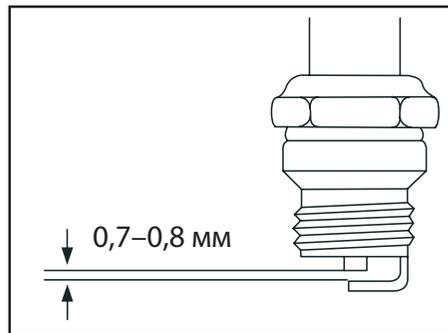
Зазор между электродами должен составлять 0,7–0,8 мм.
