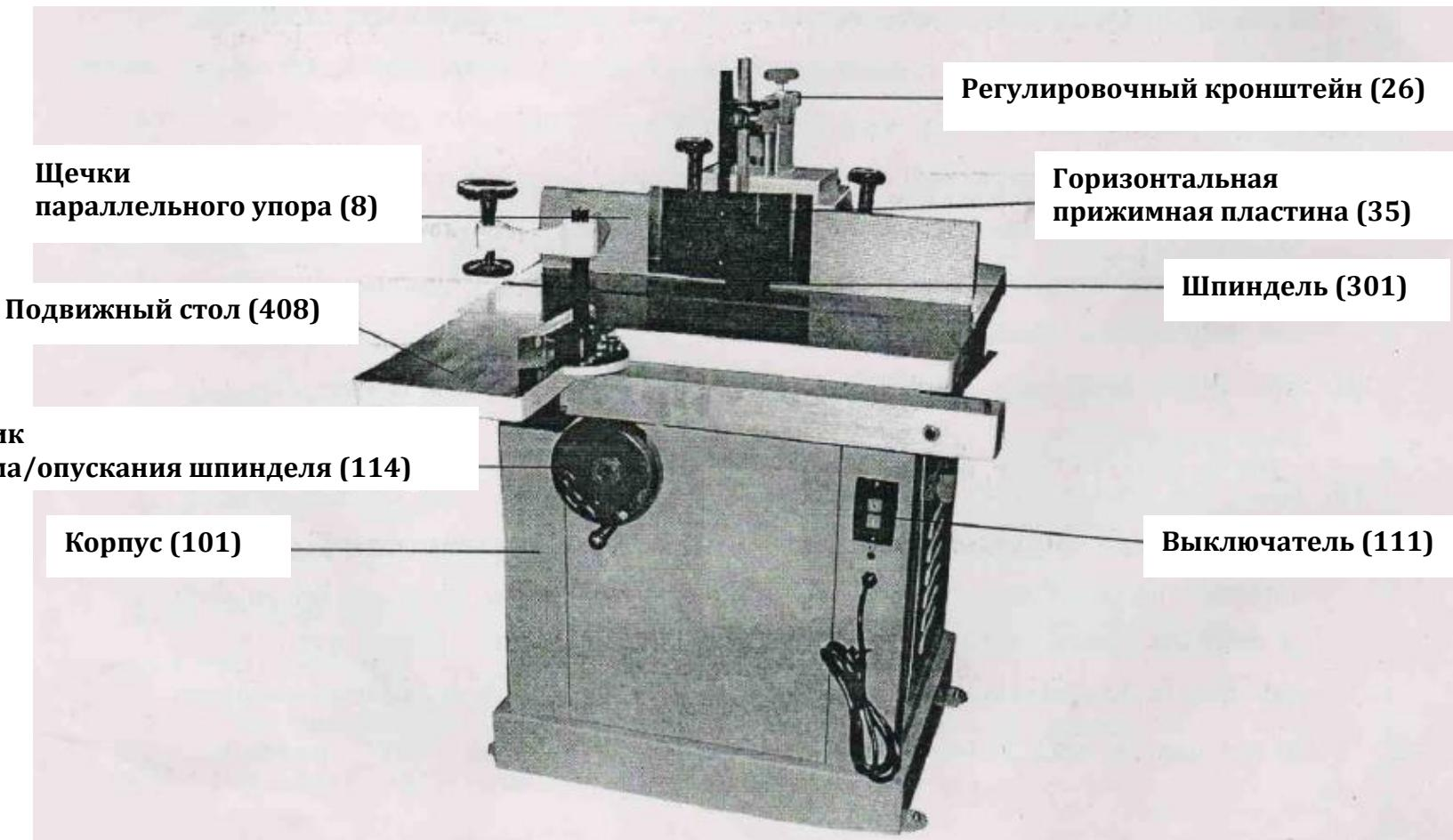
1. Отрегулировать положение параллельного упора на требуемую глубину реза, а при необходимости отрегулировать положение щечки параллельного упора 8 регулировочным винтом 18 .
