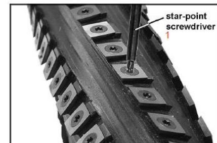
Рис. 20а: 1 – отвертка под шлиц типа Torx
