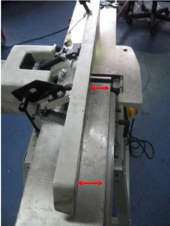
Вворачивать или выворачивать по мере необходимости один из данных установочных пальцев для выставления параллельности параллельного упора
