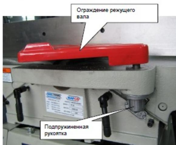
Ограждение режущего вала
