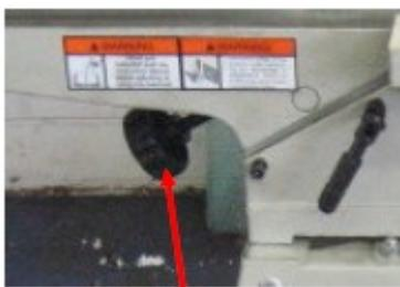
Закрепить маховичок на винте выводного стола с левой стороны станка с помощью винта с шестигранным шлицем.
