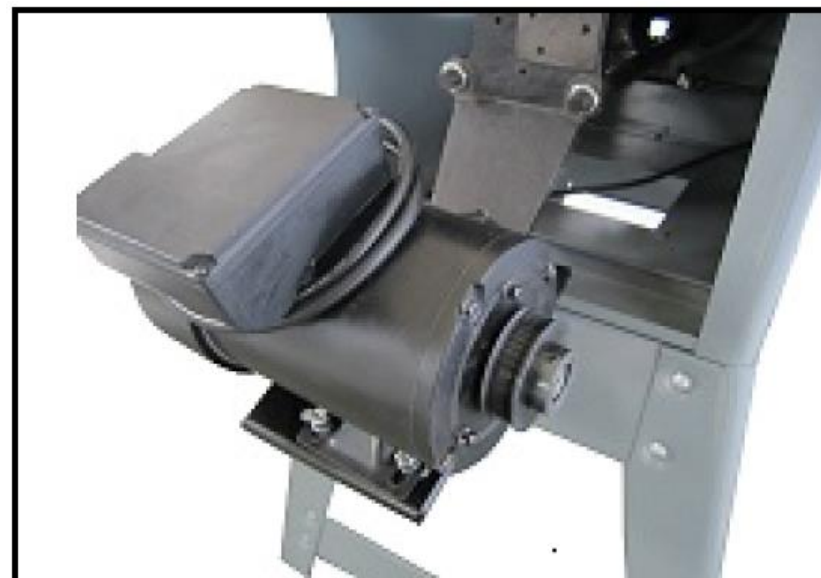
Рис. 23. Двигатель, закреплённый на монтажной плите
