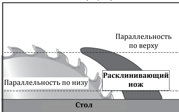
Рис. 43. Проверка параллельности по верху и низу расклинивающего ножа относительно пилы
