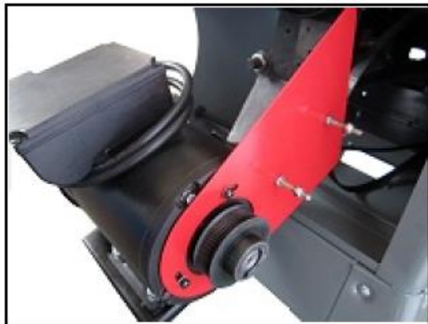
Рис. 24. Низ крышки ремня, прикреплённый к двигателю
