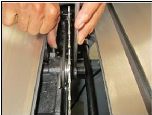
Рис. 26. Крепление дисковой пилы
