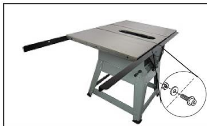
Рис. 17. Установленная на станке задняя направляющая
