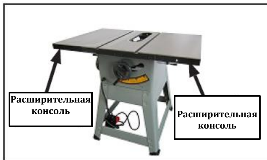
Рис. 13. Установленные на станке расширительные консоли
