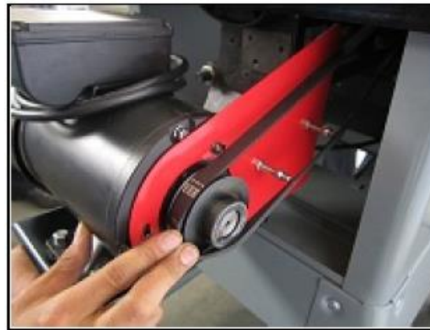
Рис. 25. Узел клиноремённой передачи
