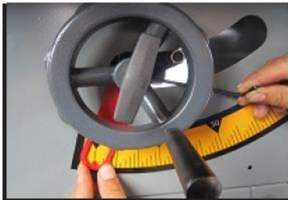
Рис. 37. Установка указателя на 0^{\circ}
