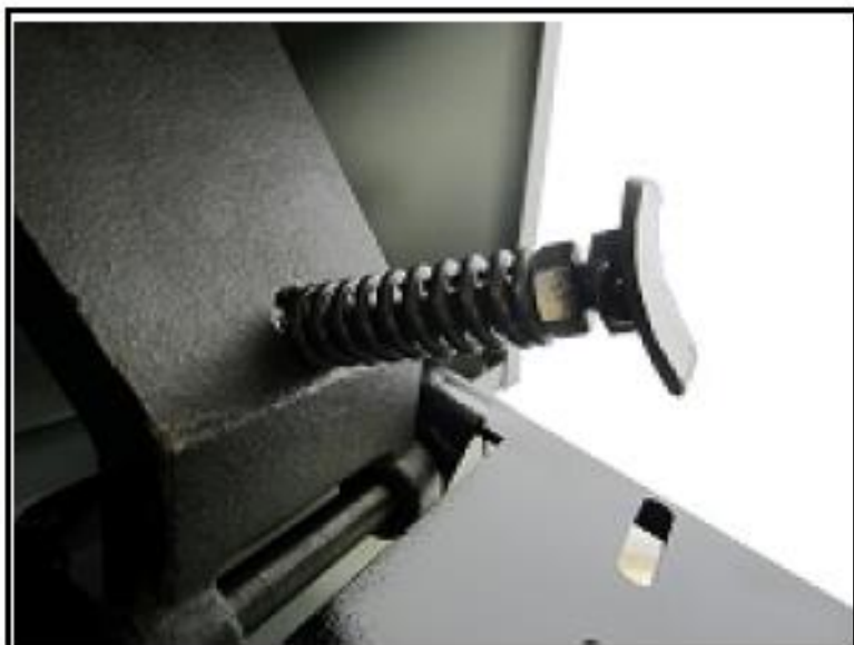
Рис. 22. Пружина регулировки натяжения ремня
