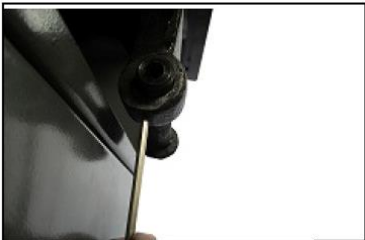
Рис. 20. Ослабить установочный винт на кронштейне двигателя
