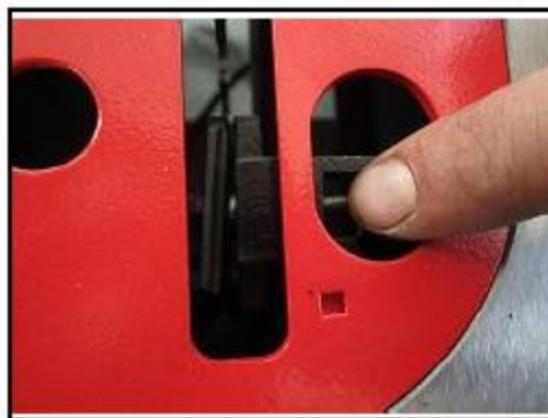
Рис. 28. Вставка стопорного штифта
