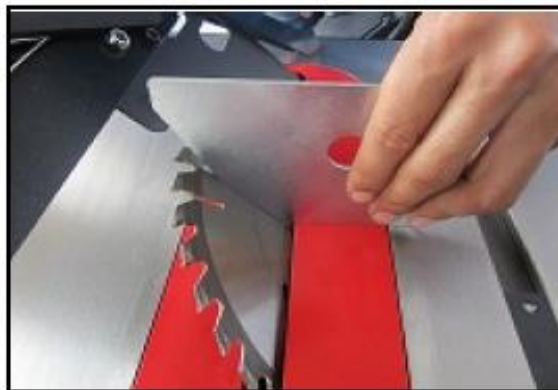
Рис. 38. Наклон дисковой пилы на угол 45^{\circ}
