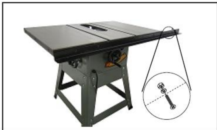
Рис. 16. Установленная на станке передняя направляющая
