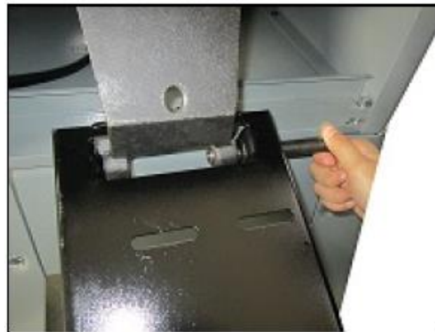
Рис. 21. Регулировка натяжения ремня
