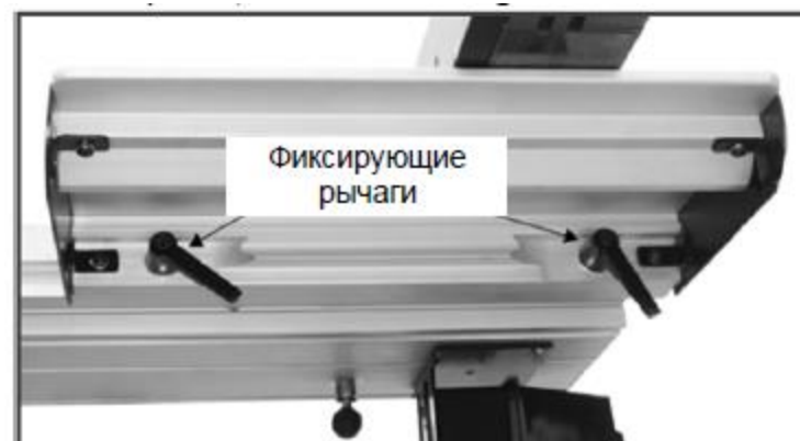
Рис. 6. Фиксирующие рычаги расширительного стола
