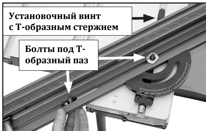
Рис. 7. Установка болтов поперечного упора в Т-образный паз
