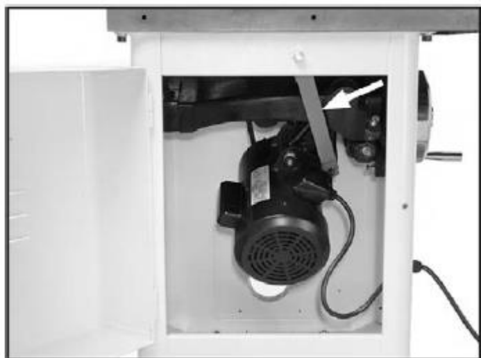
Рис. 7. Расположение транспортировочных креплений
