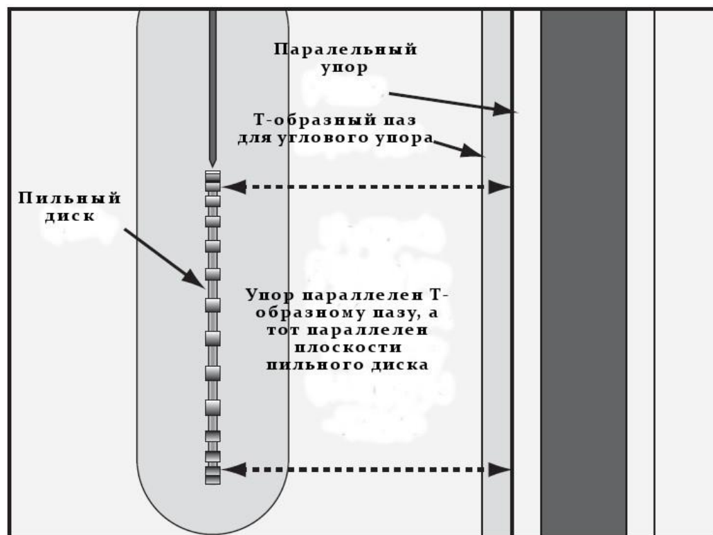
Рис. 12. Проверка параллельности параллельного упора
