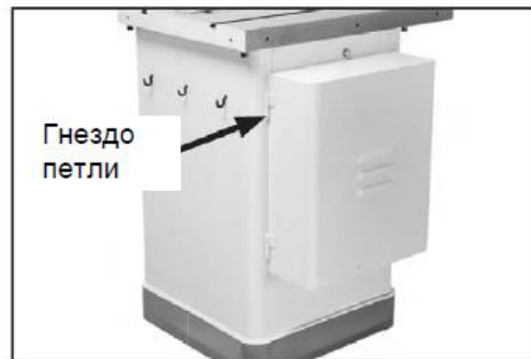
Рис.8. Установка крышки двигателя
