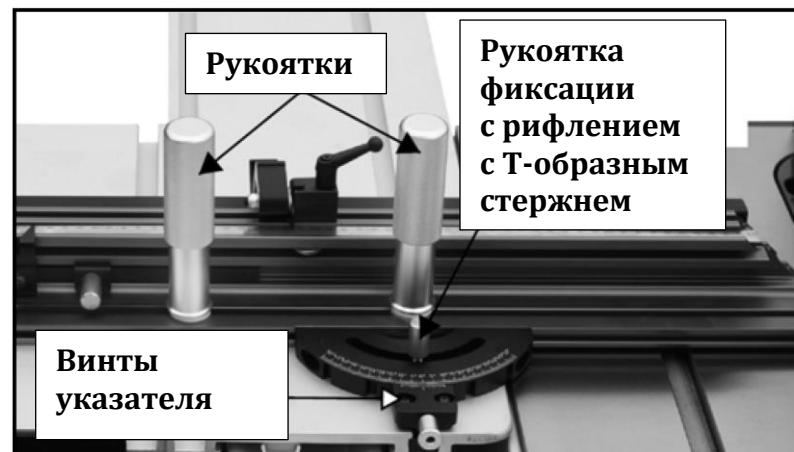
Рис. 8. Установленные рукоятки с рифлением
