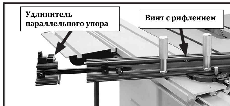
Рис. 10. Удлинитель упора, вытянутый под длинные заготовки
