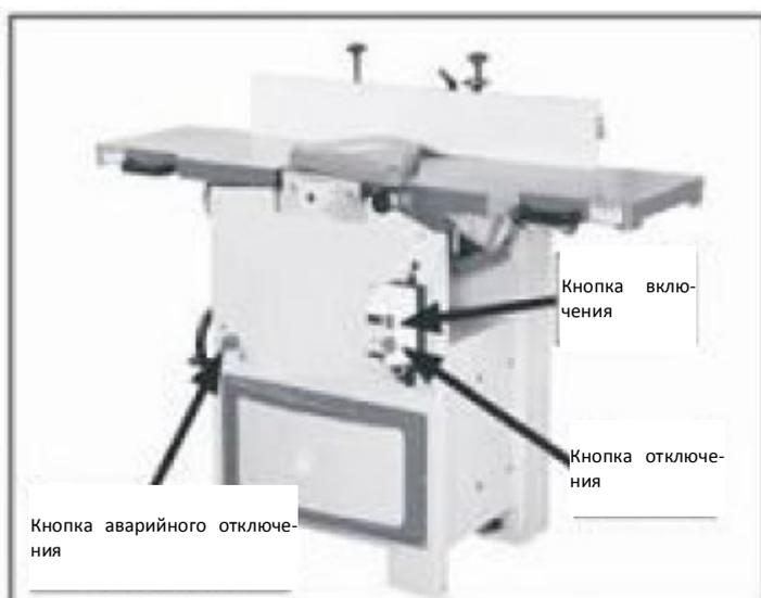
Рис. 15. Расположение кнопок включения-отключения
