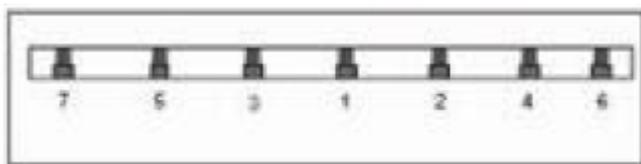
Рис. 42. Последовательность затяжки прижимной планки
