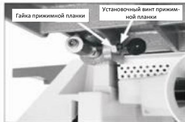
Рис. 53. Регулировка прижимной планки выводного стола
