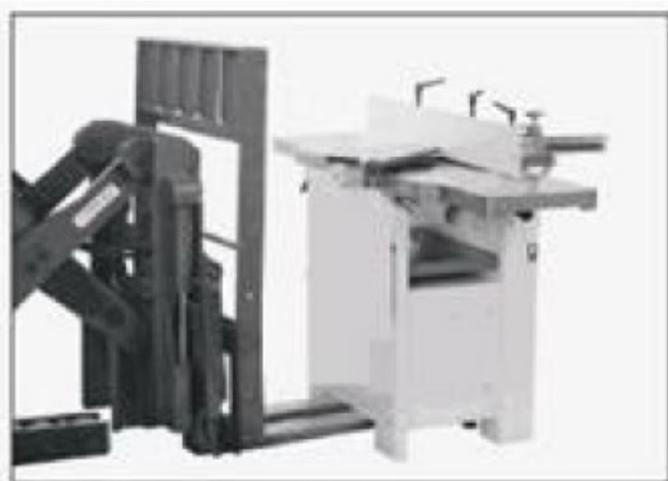
Рис. 5. Поднятие станка вилочным погрузчиком
