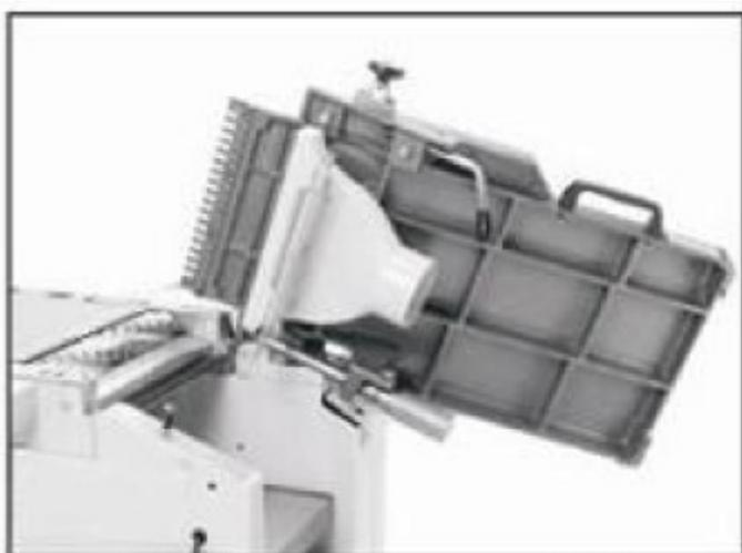
Рис. 22. Подводной стол в верхнем положении
