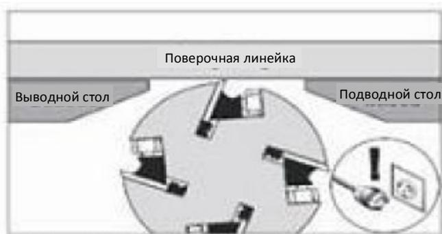
Рис. 44. Установленные вровень подводной и выводной столы
