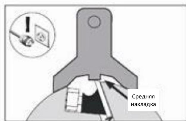
Рис. 37. Типовой калибр, помещённый на нож режущего вала
