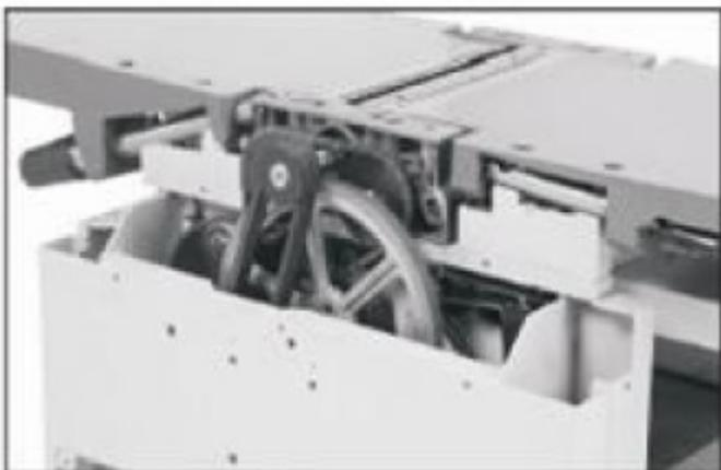
Рис. 46. Снятые параллельный упор и крышка клиноремённой передачи
