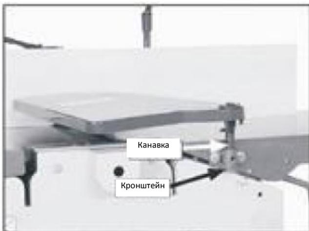
Рис. 10. Установка ограждения режущего вала
