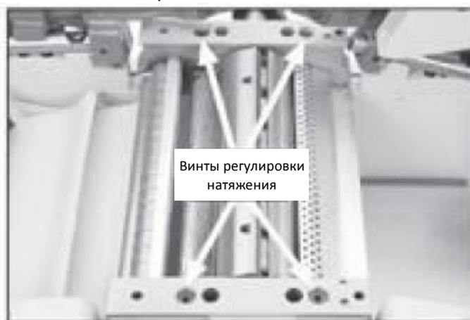
Рис. 57. Винты регулировки натяжения пружины
