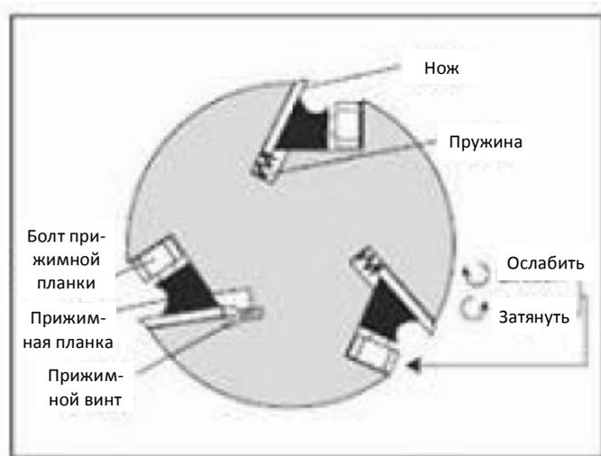
Рис. 40. Схема профиля режущего вала
