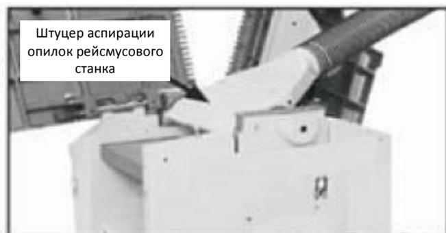
Рис. 23. Наладка штуцера аспирации опилок рейсмусового станка
