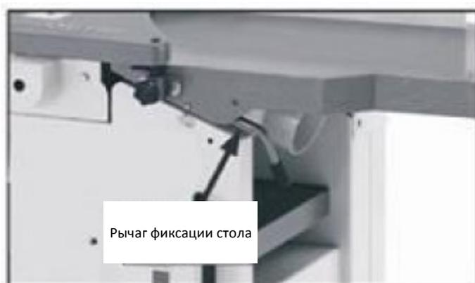
Рис. 21. Рычаг фиксации подводного стола
