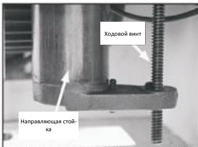
Рис. 29. Направляющая стойка и ходовой винт рейсмусового станка
