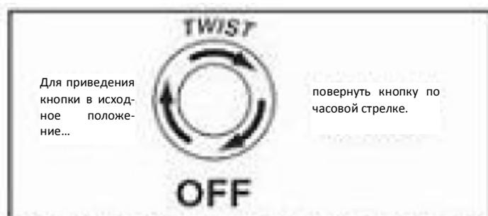
Рис. 14. Приведение кнопки аварийного отключения в исходное положение
