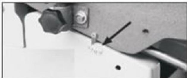
Рис. 45. Шкала глубины резания, установленная в нулевое положение
