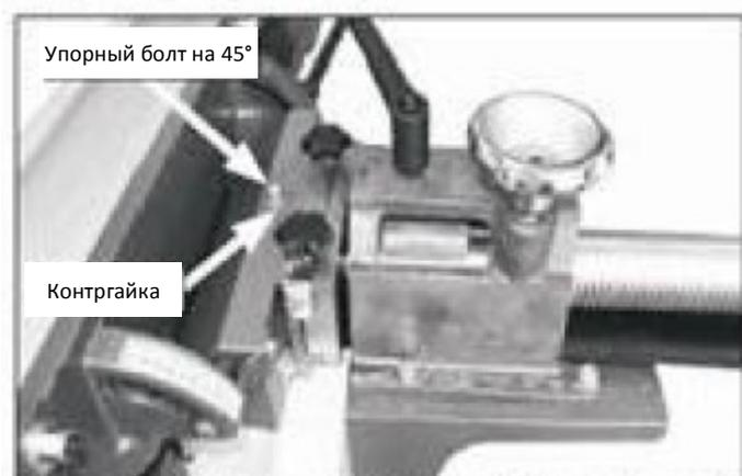
Рис. 50. Регулировка параллельного упора под 45° наружу
