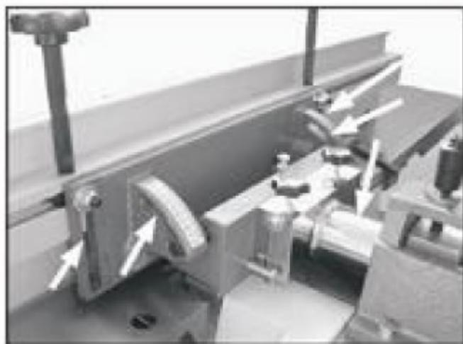
Рис. 30. Точки смазки параллельного упора
