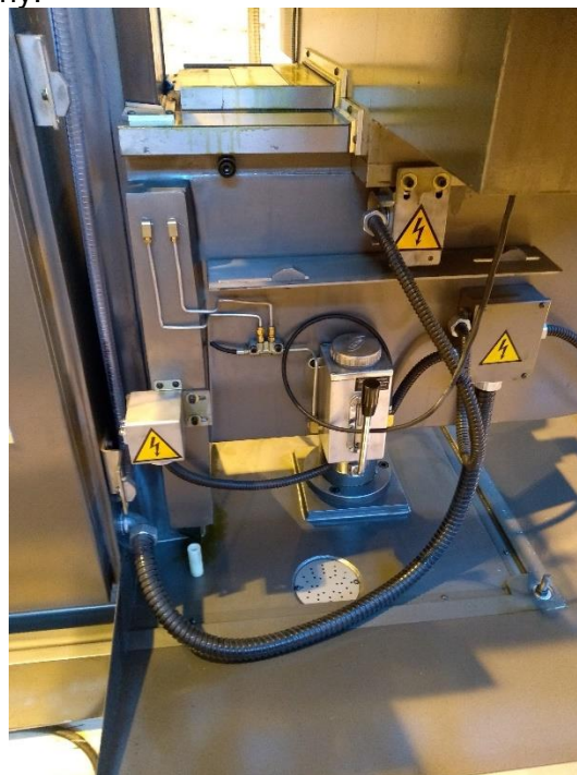
Рис. 17 Насос смазки стола
