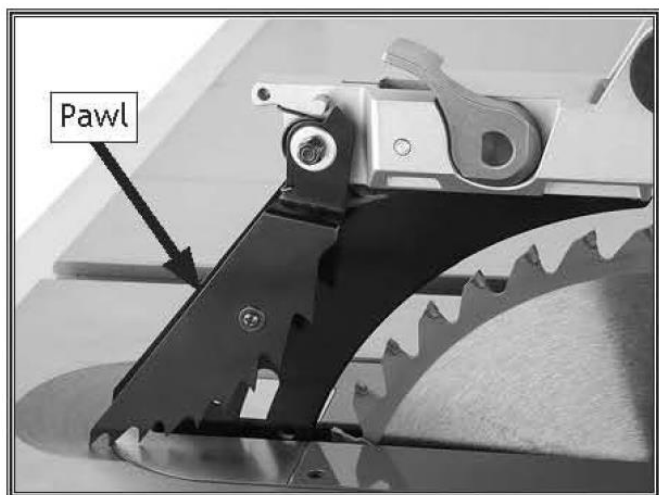
Рисунок 51. Когтевой зацеп антиотбрасывателя.
