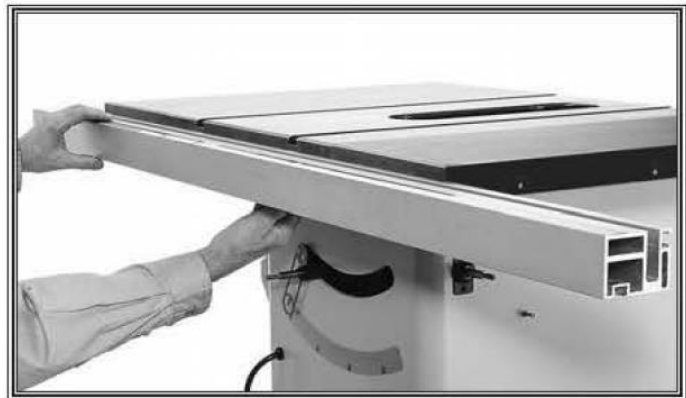
Рисунок 24. Монтаж передней части направляющей параллельного упора.
