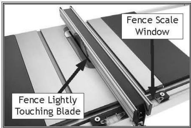
Рисунок 29. Калибровка шкалы параллельного упора.
