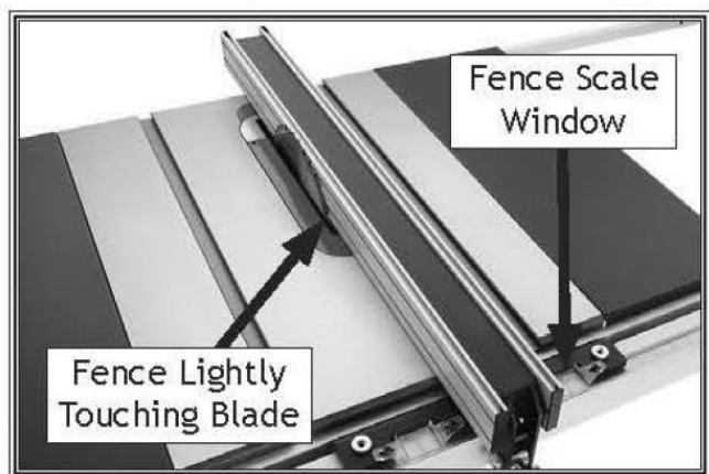
Рисунок 29. Калибровка шкалы параллельного упора.
