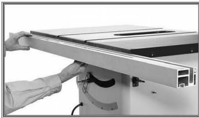
Рисунок 24. Монтаж передней части направляющей параллельного упора.
