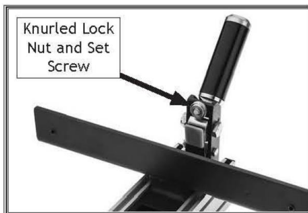
Рисунок 117. Установочный винт для регулировки давления прижима ручки ограждения.
