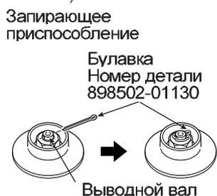
Вставьте новыми булавка в отверстие выводной вал.
