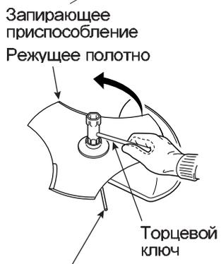
Закрутите гайку (против часовой стрелки) используя торцевой ключ.
