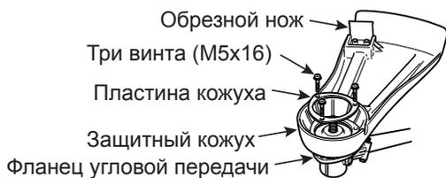
2. Установите триммерную головку с нейлоновой леской на выходной вал, согласно указаниям инструкции оператора.
