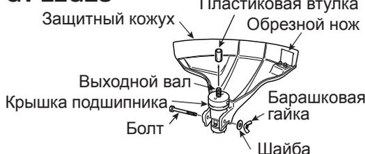
1. Установите защитный кожух с обрезным ножом (Резчик) на инструмент должным образом.
