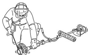
Запуск устройства - режущее приспособление в свободном пространстве.
