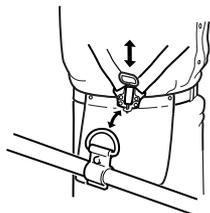
а) Передвиньте точку подвеса вниз и вверх на трубке для достижения баланса. Поверните скобу, чтобы выровнять режущее полотно и защитную крышку. Закрепите.
