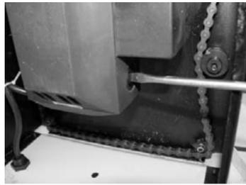
16.1. Необходимо регулярно очищать приводные шестерни от пыли и грязи с помощью щетки или сжатого воздуха. Регулярно смазывайте все подшипники, шестерни, цепные передачи и цепи небольшим количеством машинного масла. Регулярно очищайте ремни и шкивы от смазки, грязные шкивы и ремни могут привести к проскальзыванию. Изношенные ремни заменяйте - код для заказа ремней – **25651; 25675** (PJ584).
