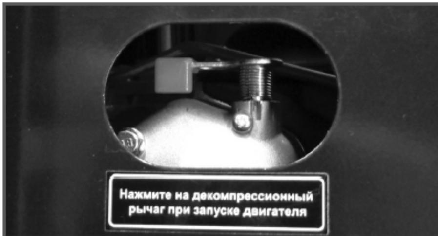
Рис. 6 Рычаг декомпрессора
